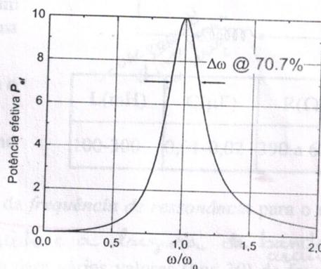
**Figura 6:** Potência efetiva em função da variação angular  $\omega$  para um circuito RLC.
