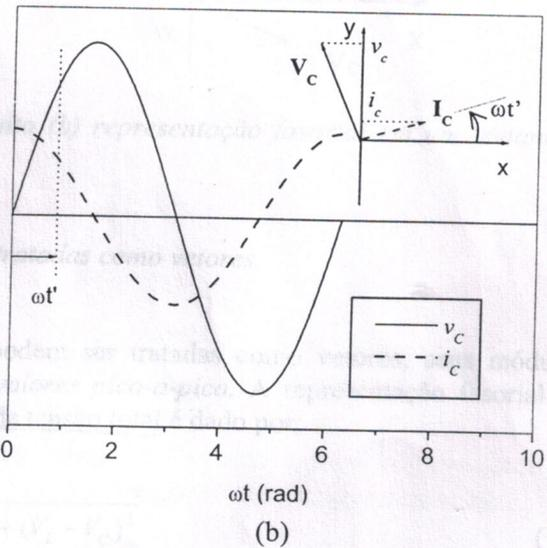
Figura 3: (a) Circuito AC capacitivo. (b) Forma de onda da tensão e da corrente no capacitor; e diagrama de fasores mostrando a relação de fases entre elas.
