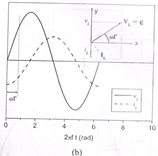
Figura 2: (a) Circuito AC indutivo. (b) Forma de onda da tensão e da corrente no indutor; e diagrama de fasores mostrando a relação de fases entre elas.
