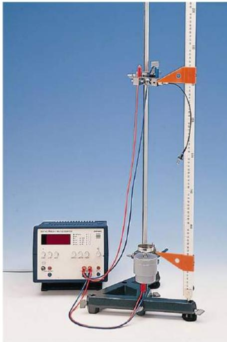
Figura 3.1: Montagem para queda livre.
