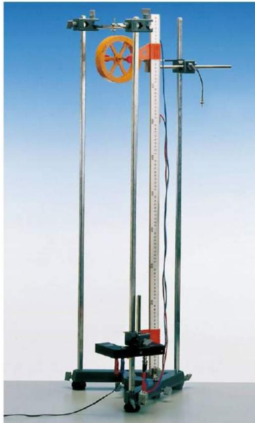
Figura 5.1: Montagem experimental para a investigação de conservação de energia, usando o disco de Maxwell.
