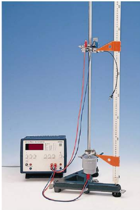
Figura 3.1: Montagem para queda livre.
