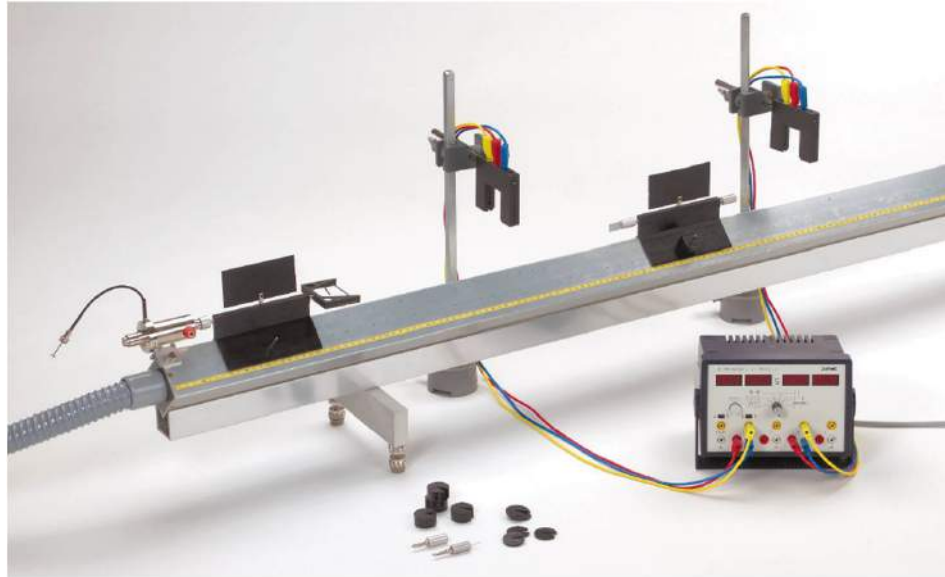
Figura 6.1: Montagem experimental para a investigação de conservação do momento linear, usando o trilho de ar.
